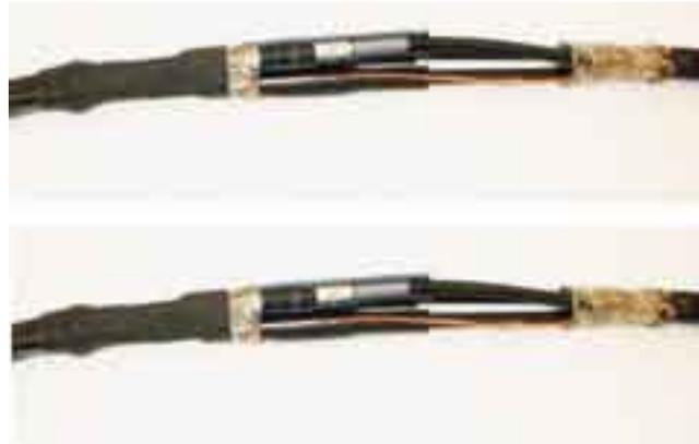
Существует два типа комплектов, в комплекте 92-AS 6x0-3 применяется холодноусаживаемый кожух, а экран кабеля соединяется при помощи медного сетчатого чулка и пружин постоянного давления, а в комплекте 92-AS 2x0-3 применяется термоусаживаемый кожух и экран соединяется путем соединения проволок экрана механическим соединителем.
