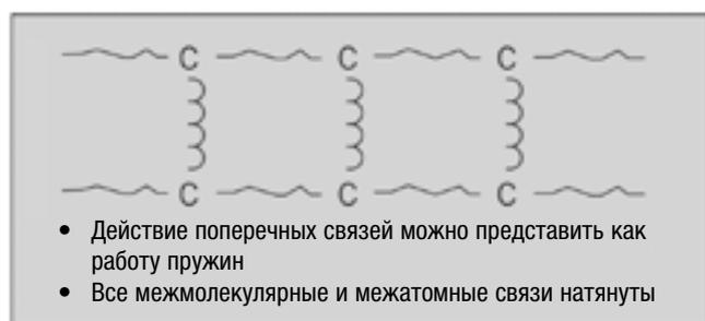
Рис. 2. Структура молекулы сшитого полимера
