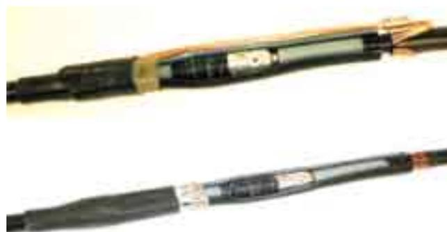
Существует два типа комплектов, в комплекте 92-AS 6x0-1 применяется холодноусаживаемый кожух, а экран кабеля соединяется при помощи медного сетчатого чулка и пружин постоянного давления, а в комплекте 92-AS 2x0-1 применяется термоусаживаемый кожух и экран соединяется путем соединения проволок экрана механическим соединителем.
