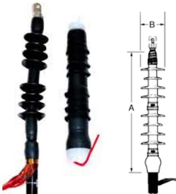
ней в районе среза полупроводящего экрана размещена мастика регулятор поля (3). Спереди муфты размещена герметизирующая мастика (4). Такое строение муфты позволяет избежать двух операций при монтаже – герметизации наконечника и заполнения среза полупроводящего экрана.
