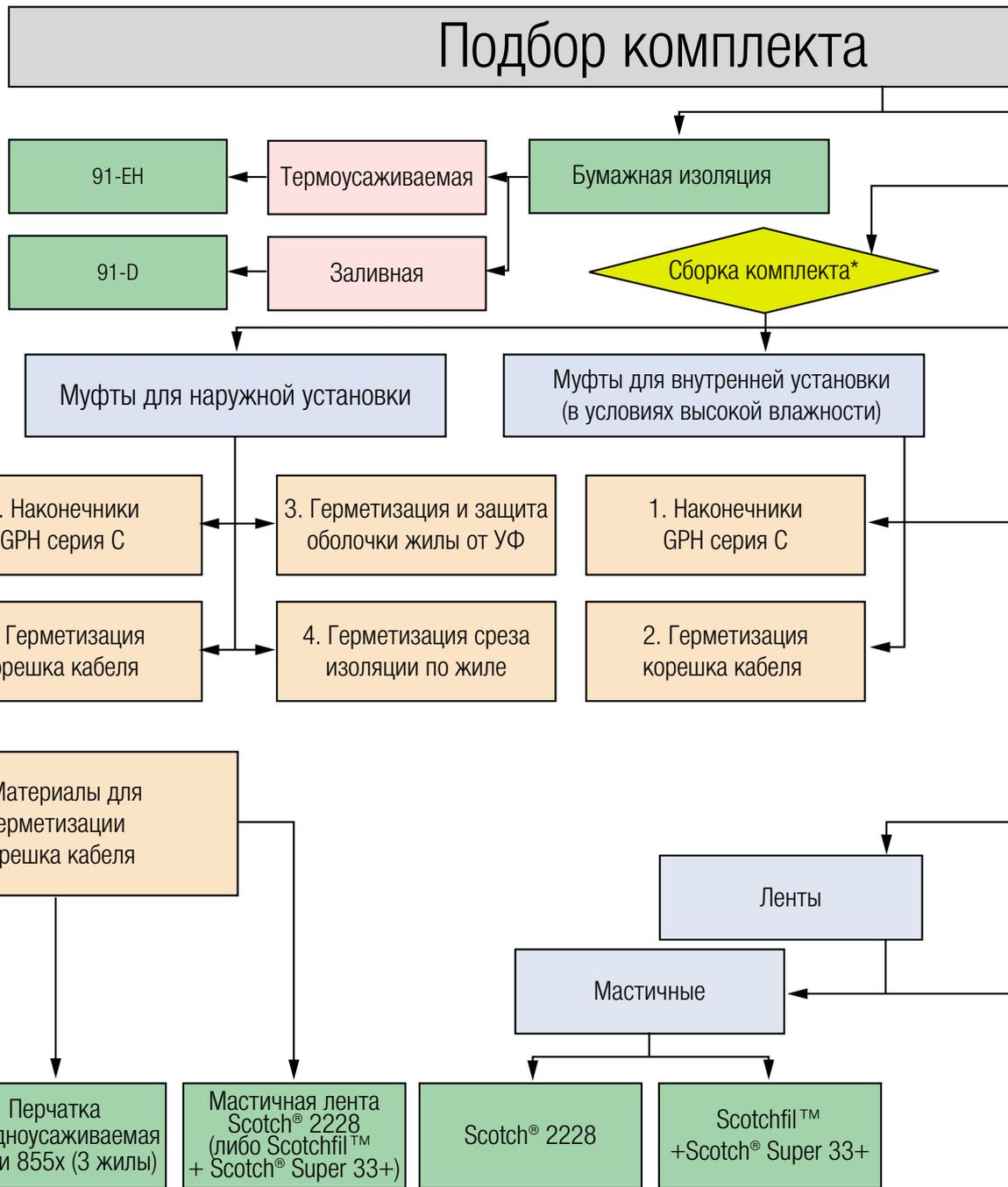
\* - Для бронированных кабелей необходимо дополнительно заказать пружинное кольцо и поводок для подключения к заземлению.
