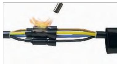
Наружная трубка устанавливается над соединением и усаживается. Эта толстостенная трубка обеспечивает механическую защиту, герметизацию соединения и восстанавливает наружную оболочку. На всей внутренней поверхности трубки нанесен термоплавкий клей.
