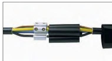
Изоляционные трубки размещаются над соединителями и усаживаются под воздействием тепла, плотно облекая соединитель и жилную изоляцию, обеспечивая одинаковую толщину стенок даже в такой неоднородной области, как болтовой соединитель. На внутренней поверхности каждой трубки нанесен слой клея, который при ее усадке плавится и растекается. Такое склеивание обеспечивает муфте герметизацию и защиту от коррозии, а кабелю дает возможность расширяться и сжиматься при тепловых воздействиях на него.
