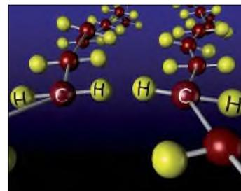
Развитие ядерной физики привело к важнейшему открытию в области материаловедения. Если пластичные материалы поместить в поток электронов высокой энергии, то происходит соединение, или сшивка соседних молекул. Эта поперечная сшивка молекул создает новую трехмерную систему внутренней структуры пластичного материала на основе новых химических связей.
