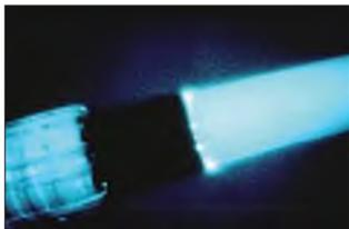
В кабельной арматуре Райхем применяются высококачественные изоляционные материалы и эффективные системы выравнивания НЭП, и как результат, уровень ЧР в муфтах не превышает 1 пКл. Для измерений ЧР требуется чувствительное оборудование, которое выделяет ЧР из шумового фона. ЧР не должны возникать при напряжении  $2xU_0$ .
