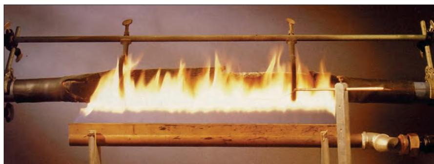
Муфта Raychem в огнестойком исполнении во время испытаний на работоспособность в течение 180 мин. в соответствии с IEC 60331.
