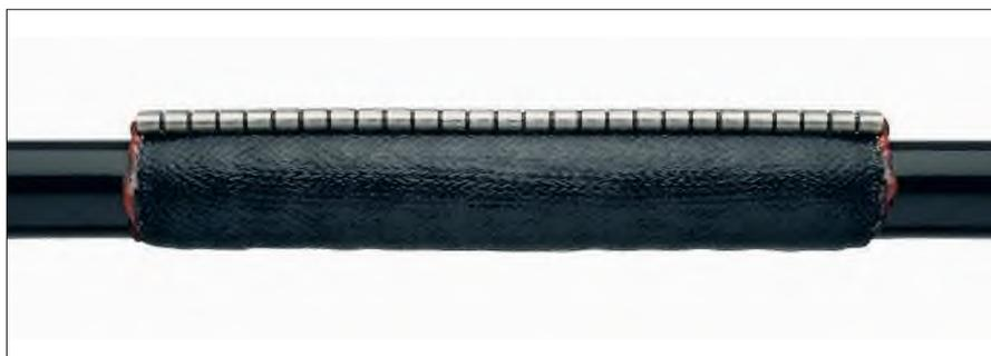
Армированные стекловолокном оборачиваемые манжеты RFSМ предназначены для быстрого и надежного ремонта кабелей и применяются там, где требуется повышенная механическая прочность. На внутренней поверхности манжеты нанесен термоплавкий клей. Манжеты RFSМ могут быть использованы в качестве наружного покрова в муфтах низкого и среднего напряжения.
