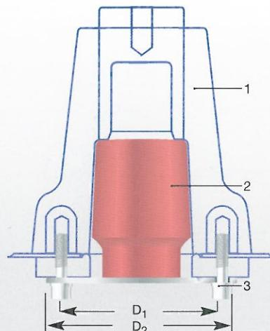
Isolierabschlüsse ISIK schließen Durchführungen nach dem Innenkonus-System spannungsfest und berührungs-sicher ab.
