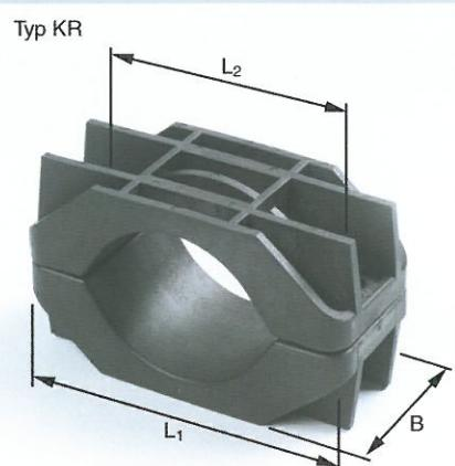
Um Kabel an Mastauführungen, in Stationen und in Kabelkanälen sicher und kurzschlussfest zu befestigen, werden Kabelschellen aus glasfaserverstärktem Polyamid eingesetzt.
